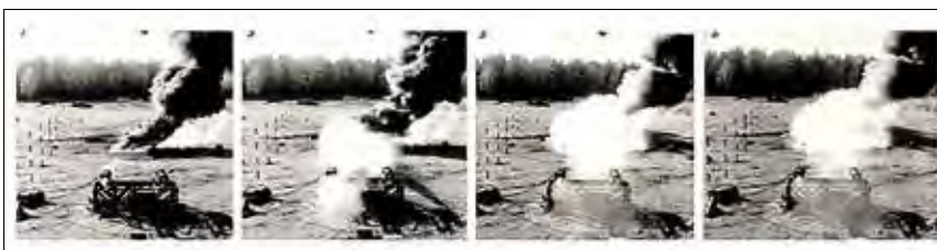
6. Кинограмма испытаний мелкодисперсного распыления воды и огнетушащего действия ИУП во время полигонных испытаний
